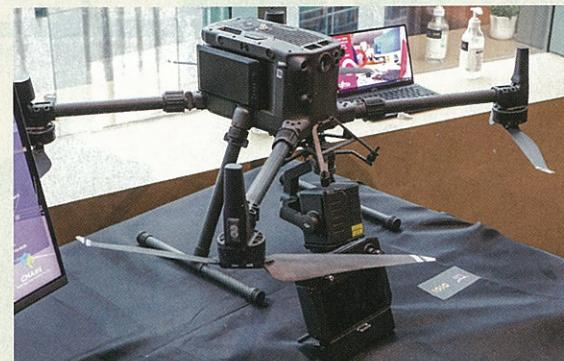
● 飛行器通過5G網絡傳送高空實時影像，通過人工智能分析並對比BIM模型，了解工程進度。
